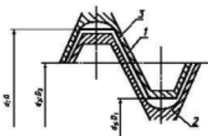
1 — поле допуска внутренней резьбы; 2 — поле допуска наружной резьбы; 3 — номинальный профиль;  $d, D$  — номинальный наружный диаметр;  $d_2, D_2$  — номинальный внутренний диаметр;  $d_1, D_1$  — номинальный средний диаметр
