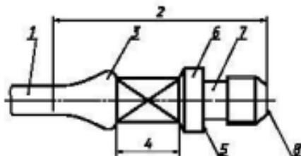
1 — тело штанги; 2 — головка штанги; 3 — подголовный бурт; 4 — квадратная шейка; 5 — торцы упорного бурта; 6 — упорный бурт; 7 — резьбовая канавка; 8 — торцы штанги
